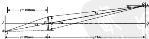
图 2.22 照射在面元 \delta_o 的像素上的光量依赖于光圈空间 d 与焦距 f 的比值平方和离轴角度 \alpha 的余弦的四次方, \cos^4 \alpha
