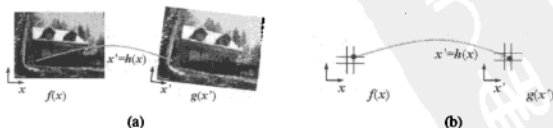
图 3.46 前向卷绕算法：(a) 一个像素 f(x) 被复制到图像 g(x') 中的相应位置 x' = h(x) ；(b) 源像素位置和目标像素位置的细节
