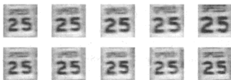
图 4.28 使用仿射运动模型进行特征跟踪(Shi and Tomasi 1994)© 1994 IEEE, 上一行: 跟踪到的特征位置附近的图像块。下一行: 使用仿射模型往后朝着第一帧变形后的图像块。尽管速度指示符逐帧在变大, 仿射变换在最初帧和后续跟踪帧之间维持了一个较好的相似性
