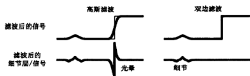
图 10.23 高斯滤波和双边滤波(Petschnigg, Agrawala, Hoppe et al. 2004)© 2004 ACM: 高斯低通滤波模糊所有边缘, 因此在细节层图像上有强烈的尖峰和低谷, 从而造成光晕。双边滤波不平滑强烈的边缘, 因而减少了光晕并仍能保留细节
