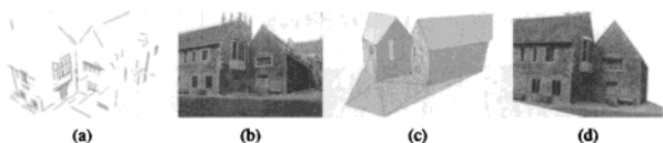
图 12.16 利用 3D 直线和平面的自动建筑重建(Werner and Zisserman 2002)© 2002 Springer: (a)重建的 3D 直线, 根据其消失方向着色; (b)叠加在输入图像上的线框模型; (c)带窗户的三角面片模型; (d)最终带纹理映射的模型
