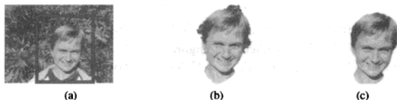
图 5.24 GrabCut 图像分割(Rother, Kolmogorov, and Blake 2004)© 2004 ACM: (a)用户画一个红色的边界框; (b)算法猜测物体与背景的颜色分布并执行二值分割; (c)该过程采用更好的区域统计量重复进行
